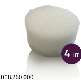
008.260.000 ФІЛЬТР ЗВОРОТНОГО ПОВІТРЯ Поролон к25 Ø35x20 Періодичність заміни: 1 раз/3 місяці
