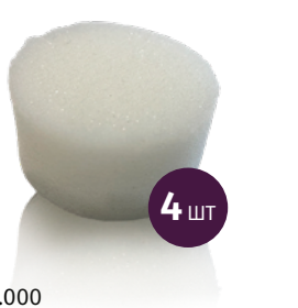
008.260.000 ФІЛЬТР ЗВОРОТНОГО ПОВІТРЯ Поролон к25 Ø35x20 Періодичність заміни: 1 раз/3 місяці
