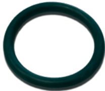
94.3771.020-024-2,5 СЧВ КІЛЬЦЕ УЩІЛЬНЮЮЧЕ ISC O-RING20X24X2,5 88NBR 156 (GREEN) Періодичність заміни: 1 раз/рік
