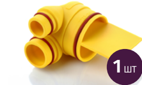
0725-041-05 КРИШКА (ЖОВТОГО) ФІЛЬТРА з ущільнювачами (червоні кільця) Періодичність заміни: 1 раз/3 місяці
