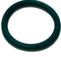
94.3771.020-024-2,5 СЧВ КІЛЬЦЕ УЩІЛЬНЮЮЧЕ ISC O-RING20X24X2,5 88NBR 156 (GREEN) Періодичність заміни: 1 раз/рік
