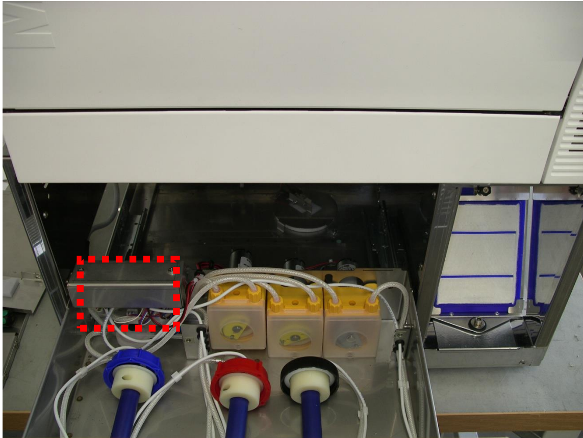
Электронный дозатор (Melag Артикул № 62160)
