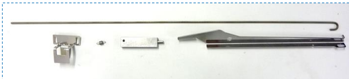
Замок дверцы аварийного сброса
