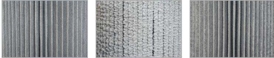
Рисунок 2: Порівняння: новий фільтрувальний картридж; використаний фільтрувальний картридж; фільтрувальний картридж після очищення за допомогою стисненого повітря
