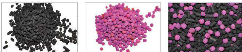
Рисунок 4: Гранули активованого вугілля, гранули \text{KMnO}_4 (BAC), суміш активованого вугілля та BAC
